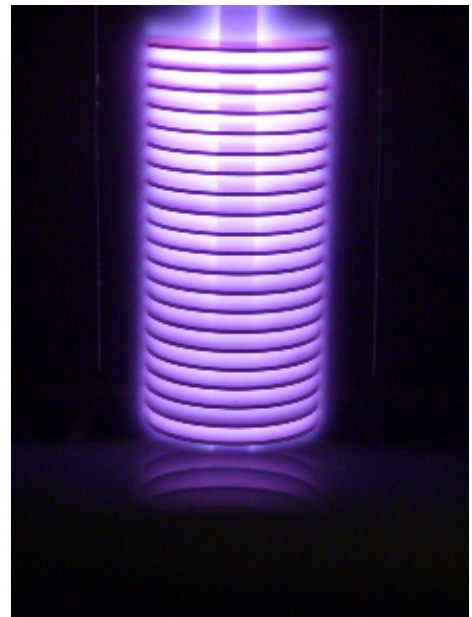
写真 2b. 円盤形状物狭ピッチ処理の放電状態
